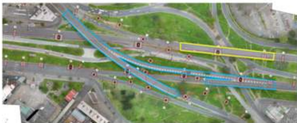
Estructuras existentes a demoler
